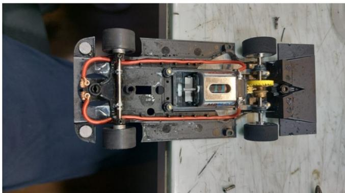
E' possibile utilizzare sistemi di regolazione dell'altezza e posizione dell'assale anteriore mediante l'uso di grani a brugola, purché siano predisposti dal produttore e che i grani non fuoriescano dalla parte inferiore del telaio.
